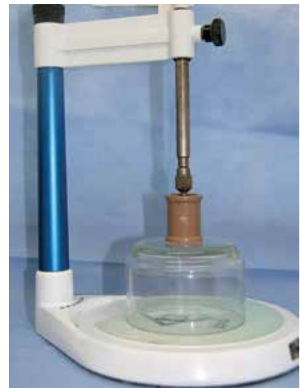
Figura 2 - Análogo do implante posicionado com o auxílio de um delineador no tubo de PVC.
