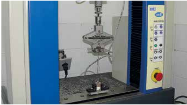
Figura 9 - Máquina EMIC com corpo de prova posicionado para teste.
