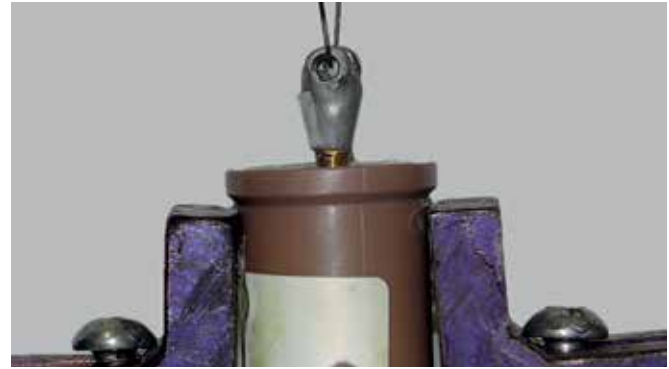
Figura 10 - Vista aproximada do corpo de prova posicionado na máquina EMIC para teste.
