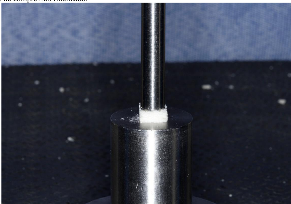
Figura 4. Bloco ósseo xenógeno do Grupo 2 (Bio-Graft) posicionado na máquina universal de testes. Teste de compressão finalizado.
