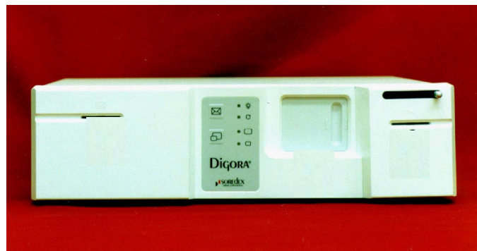
Figura 9 - Escaner de leitura ótica (laser) - Sistema Digora de Imagem (ERENO, 2007)
